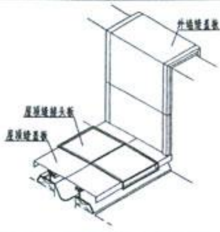
屋顶缝与外墙缝节点图
